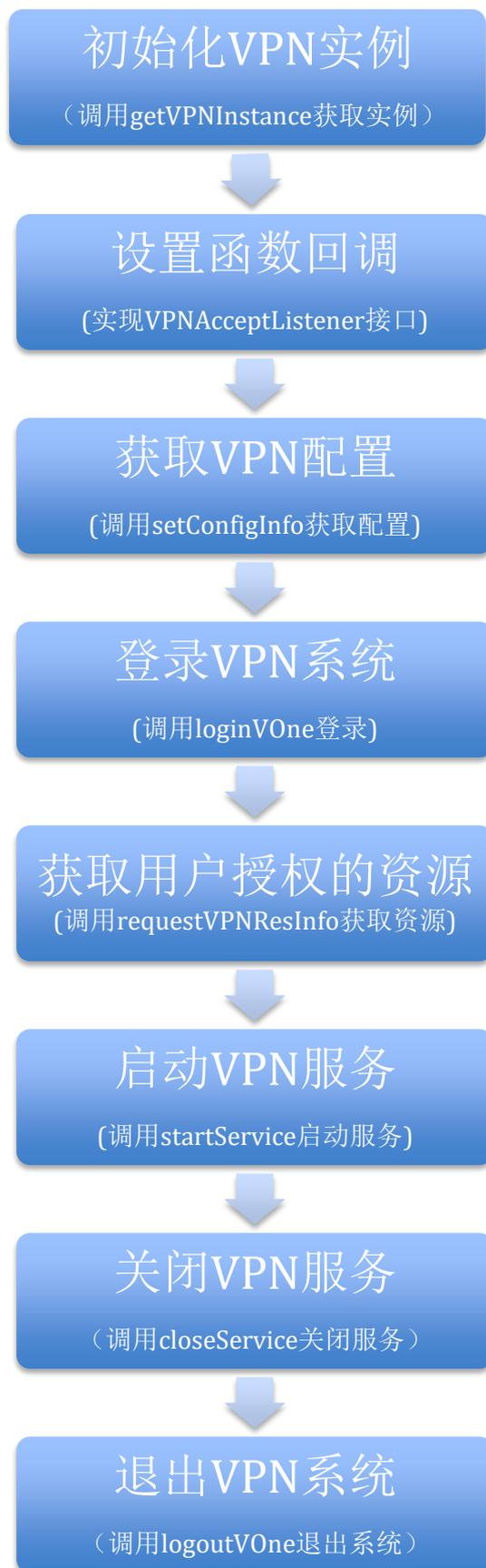
Figure 1 VPN 工作流程
